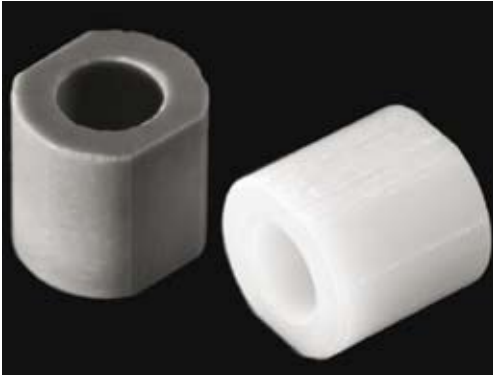
Lagerbuchsen aus \text{SiC} , \text{Si}_3\text{N}_4 und \text{ZrO}_2
